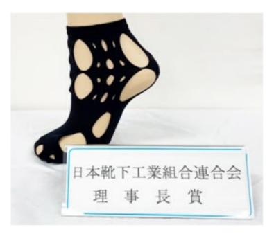
水溶性繊維を編立後、溶解することで一般的な丸編み機で目流れを発生させずにホール 形状を編成することができます。本作品は指有り5本指オープントゥを縫製や横編み機を 用いることなく、丸編み機を用いて実現しました。
