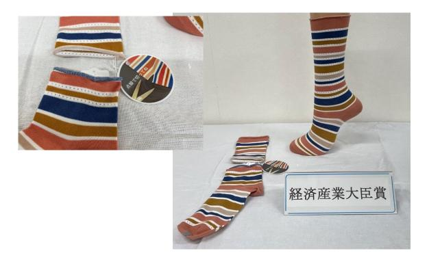
切手のミシン目をイメージし、穴目でカット位置を表現。穴目の下部には熱融着ナイロンを挿入 し、ほつれが止まる仕様になっています。カット位置はゴム挿入のないシングル生地のため外側に カールしたトップロール状になり、カット部分を覆い隠します。
