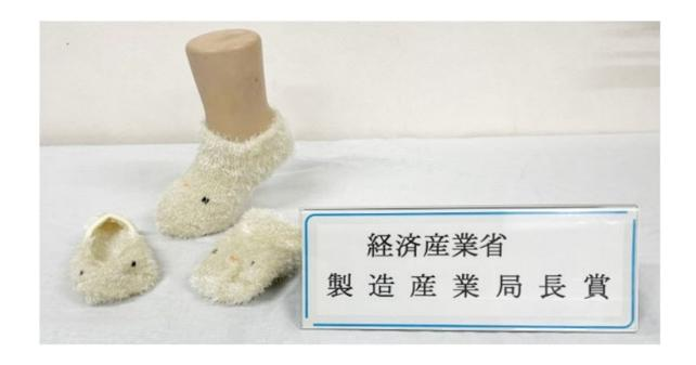
編機の針数を半分に削減し、付帯部品も換装することでシリンダーを変更することなく 小径の編地を編成します。
