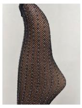
透明度の高いマイクロメッシュ生地のベースにストライプ状に配置された2色のピンドットが、まるでガラス細工のビーズが立体的に浮きだって見えるように構成されています。ベースにコンジュゲート糸を選択し、より透明感が出るようにダイヤ柄にはDCYを1コース使用することで細くクリアなラインを実現。このベース生地の上で表現される2色のピンドットは非常に細かな連なりでありながら、それぞれが独立したピンドットとして表現するため、カットボスのナイフの高さをギリギリまで調整して端末が目立たなくしました。
